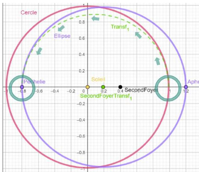
La vitesse du satellite en tout point de l'ellipse est donnée par la formule  $v = \sqrt{\mu \left( \frac{2}{r} - \frac{1}{a} \right)}$  avec " $r$ " le "rayon-vecteur", c'est-à-dire la distance entre le satellite et le foyer de l'ellipse. On en déduit donc les formules suivantes simplifiées pour le périhélie et l'aphélie d'une ellipse dont on connaît le demi-grand axe  $a$  et l'excentricité  $e$  :
