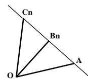
On considère des polygones réguliers circonscrits au cercle de rayons 1/2, à 4, 8, 16, ...,  $2^n$  côtés. Le cercle est tangent à chacun des côtés du polygone, en son milieu. Pour un polygone régulier à  $2^n$  côtés, l'angle au centre AOC mesure  $360/2^n$  degrés et l'angle  $AOB_n$  mesure la moitié :  $180/2^n$  degrés.  $B_n$  est le milieu de  $[AC_n]$ ,  $OB_n = 1/2$  et  $(OB_n)$  est perpendiculaire à  $(AC_n)$ .
